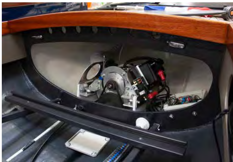
DE COMPACTE INDUCTIEMOTOR VAN 1,7 KILOWATT; HIER OVERIGENS MET EEN VOOR ONDERHOUD GEOPENDE KABELDOOS, RECHTS. Foto's Laurens van Zijp
