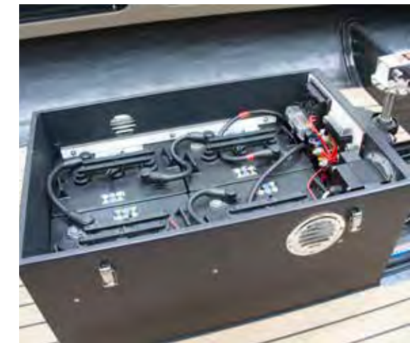
HET ACCUPAKKET ZIT IN EEN 'MOTORKIST' MIDSCHEPS.
